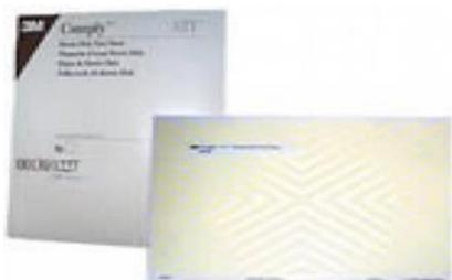
El paquete de test se debe rotular con cinta testigo colocando fecha, número de ciclo y persona que realiza el proceso; el paquete se debe colocar en la cámara vacía del esterilizador lo más cerca al sitio de desagüe y situarlo en posición horizontal equidistante a las paredes laterales de la cámara y realizar el ciclo correspondiente a ciclo de vacío
