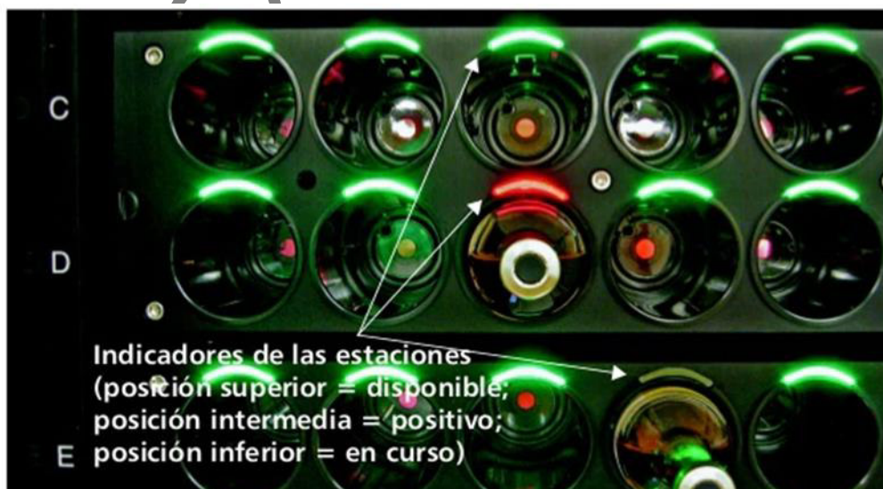
Ilustración 9. Imagen del equipo con las diferentes alarmas visuales.
